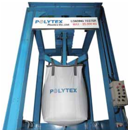
FIBC BAG TEST RIG(Max. 20,000kg)
